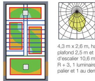
4,3 m x 2,6 m, hauteur sous plafond 2,5 m et hauteur de la cage d'escalier 10,6 m, simulation sur un R + 3, 1 luminaire en plafonnier au palier et 1 au demi-palier.
